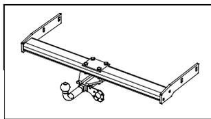
**Bild Nr. 01 Längsträger (Pos 20) <750mm**
