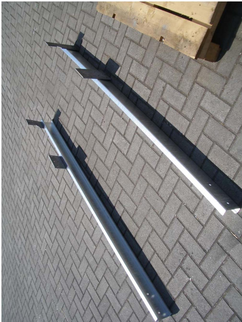
Platten sollten von außen an das Chassis geschraubt werden
